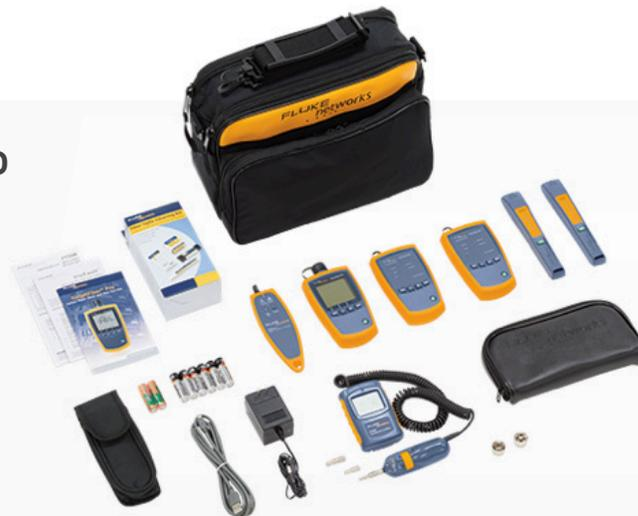
Este es un kit completo para contratistas y técnicos de la red que instalan y mantienen redes con fibras ópticas multimodo y monomodo (ambas). Use este kit para verificar la pérdida de potencia óptica en la fibra en longitudes de onda de 850, 1300, 1310, 1490, 1550, y 1625 nm, inspeccione la cara de las terminales de la fibra, localiza fallas en el cable, problemas de conectores, y problemas de polaridad.
